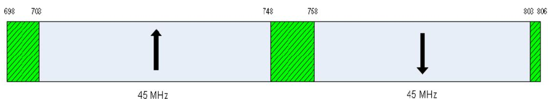
圖 4-4 700MHz 之 Guard band 與 inter-band gaps 配置圖
