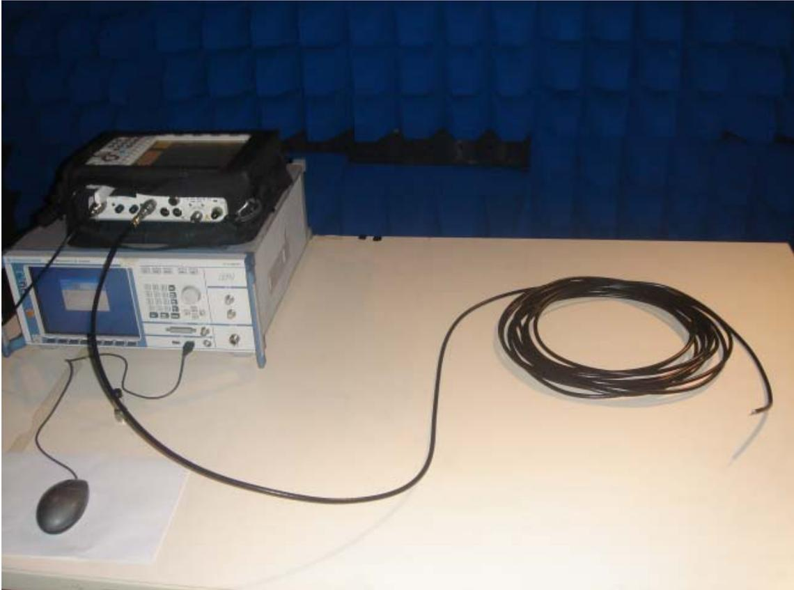
圖 3.12 纜線短路之電波洩漏量測
