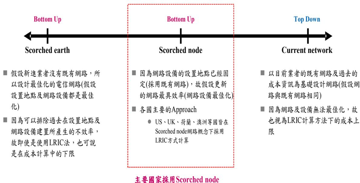
圖 2-10 Bottom Up/Top Down 網路設計示意圖
