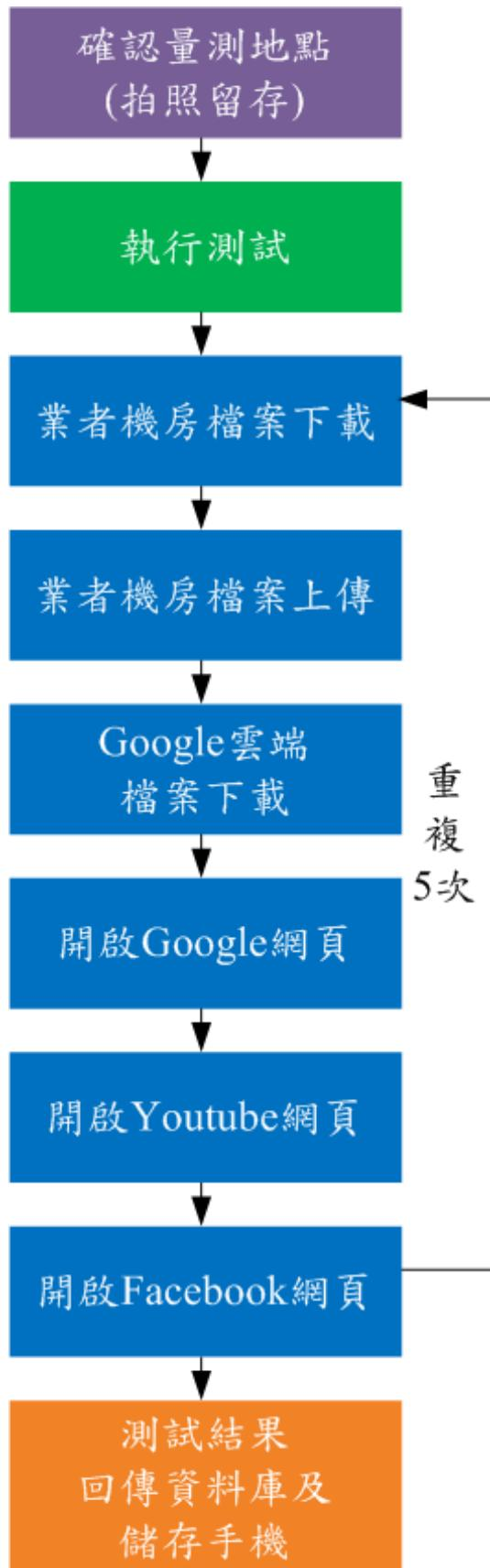
圖 2.4 定點測試量測流程
