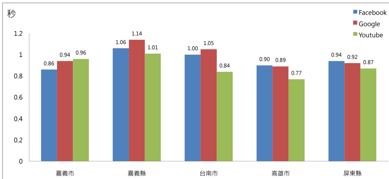
圖 4.8 第二階段定點量測-南區各縣市三大網頁開啟平均時間
