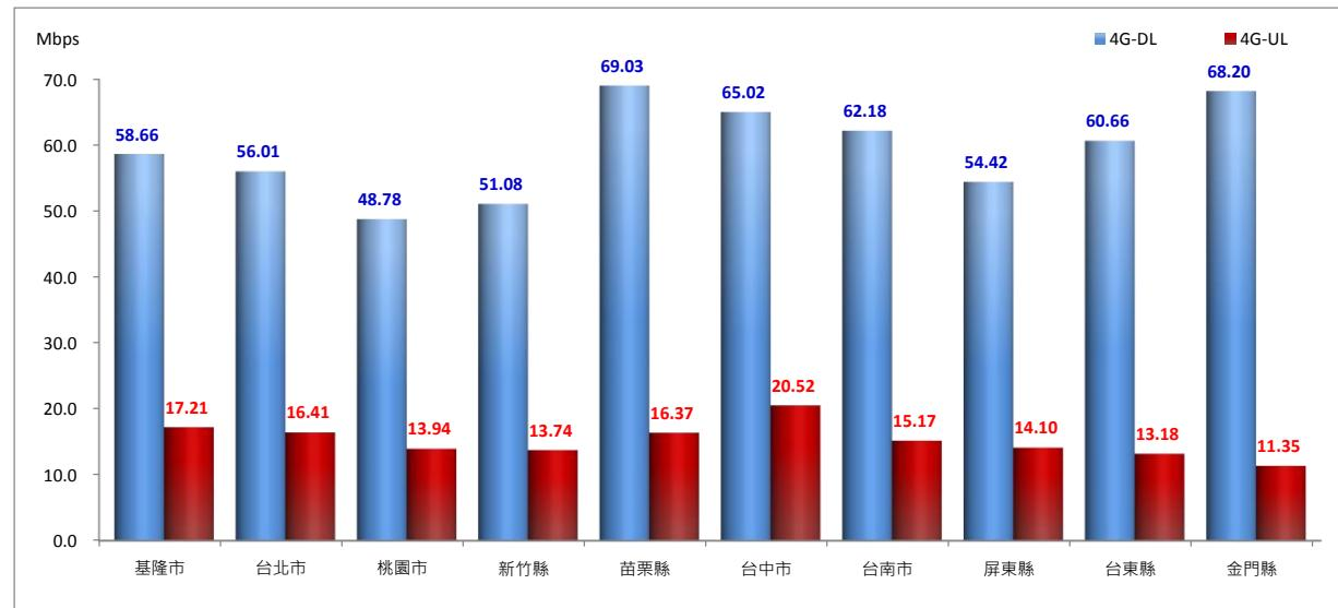
圖 4.15 第二階段移動式量測（4G）-縣市速率平均值
