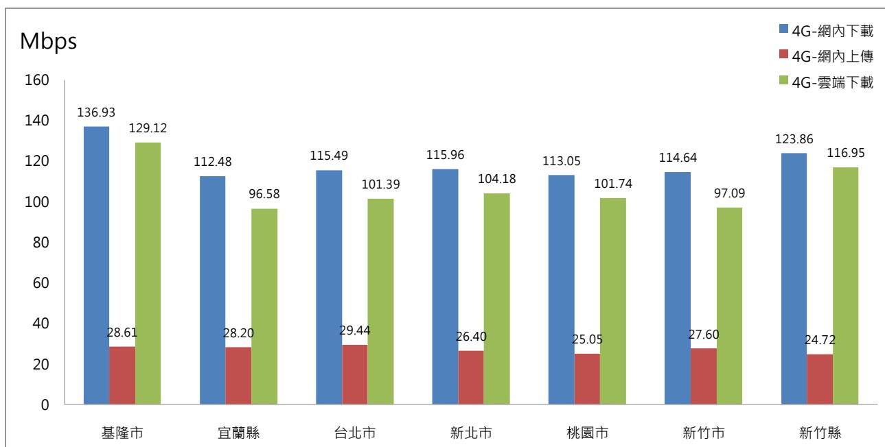
圖 4.2 第二階段定點量測-北區各縣市速率平均值
