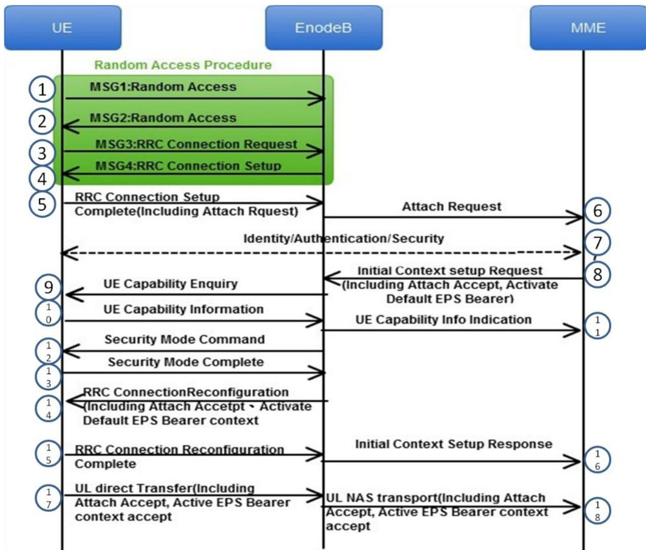
圖 2.8 手機連網動作示意圖
