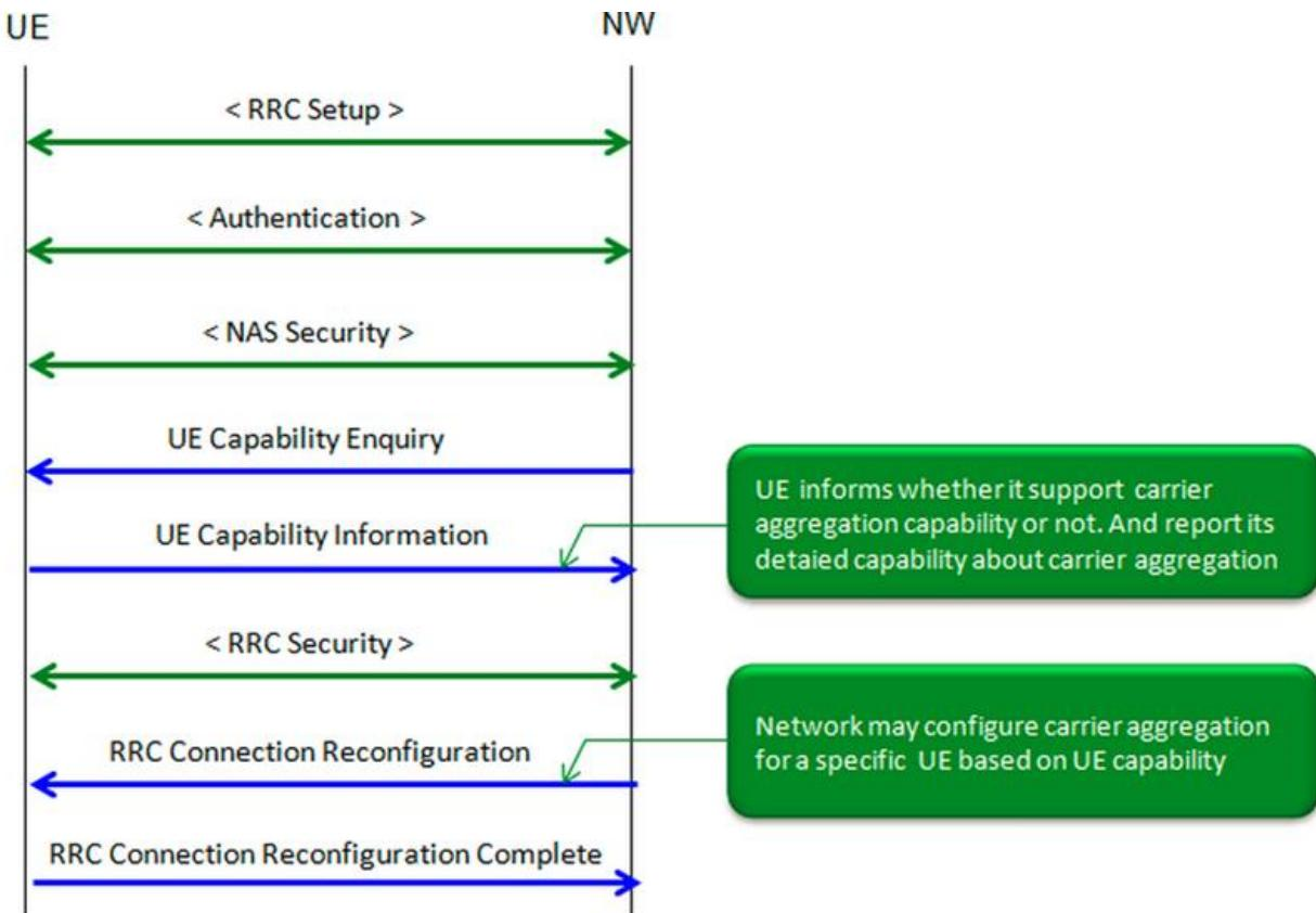
圖 2.15 載波聚合 RRC 建立機制與流程圖
