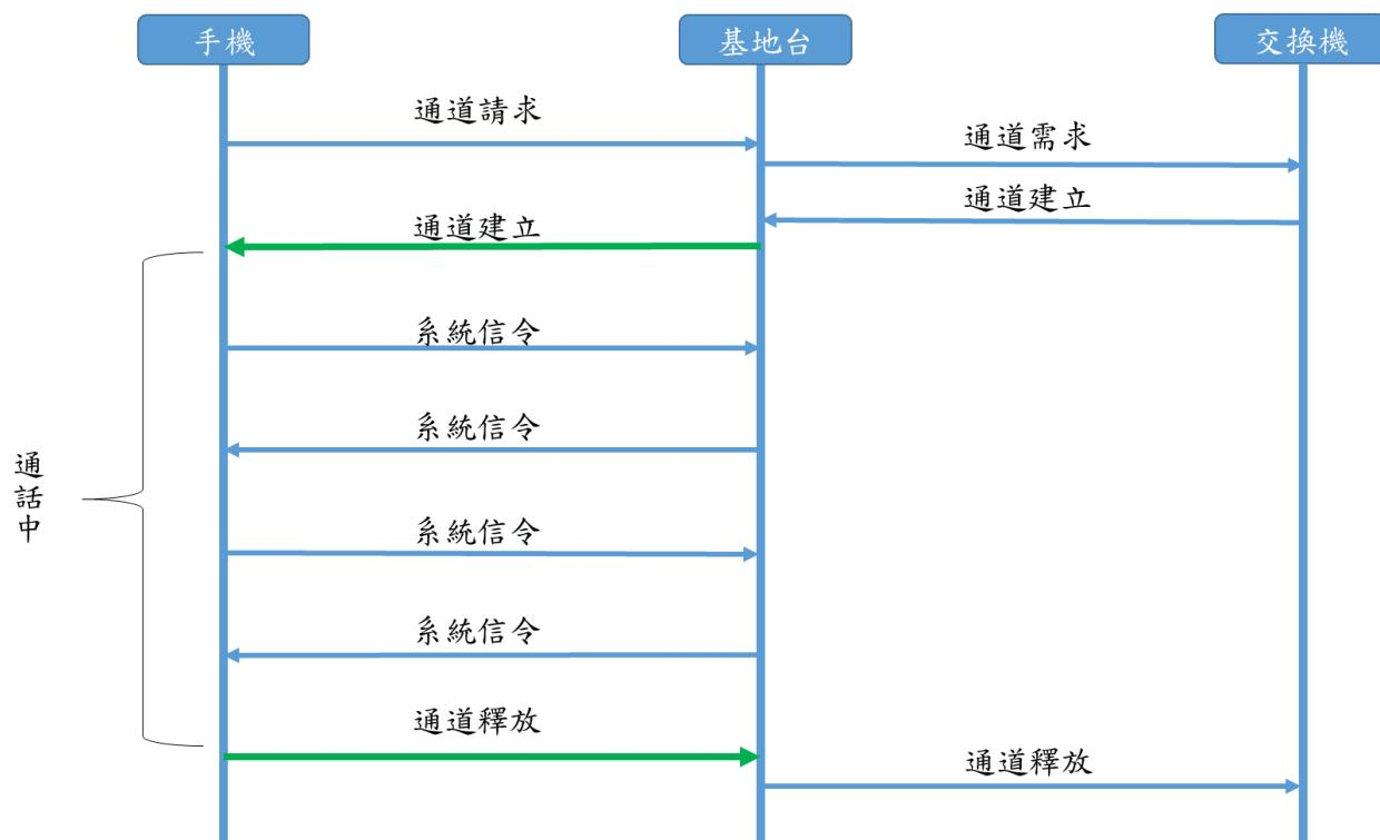
圖 2.10 用戶通話系統信令流程
