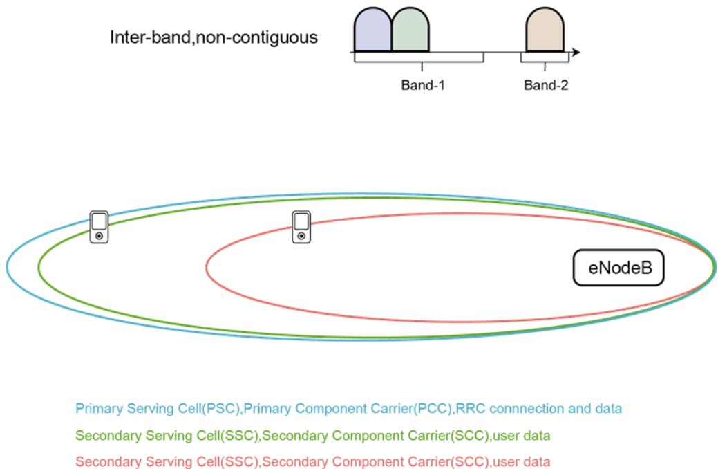
圖 2.13 載波特性與用戶位置造成載波聚合組合不同示意圖
