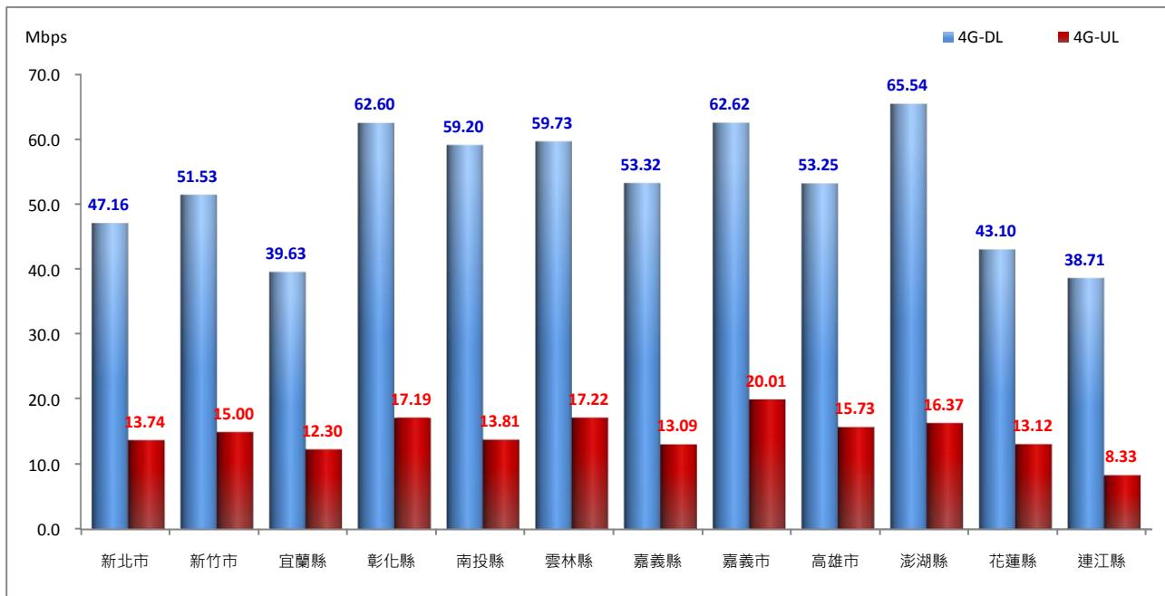
圖 3.11 移動式量測 (4G) - 縣市速率平均值
