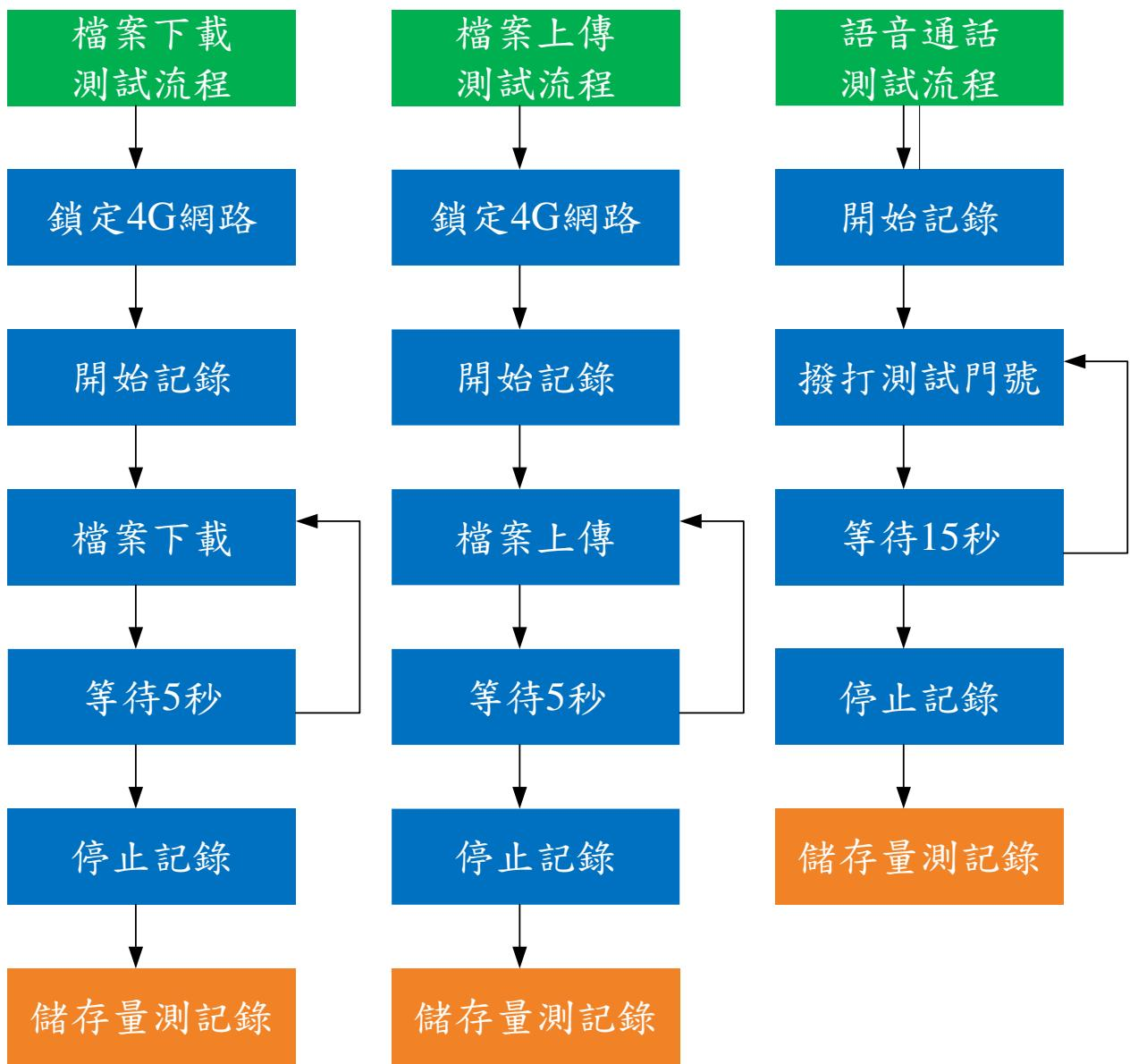
圖 2.5 移動式量測自動化測試流程
