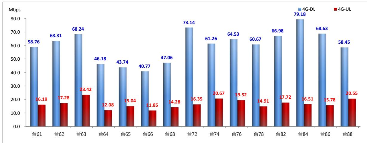
圖 4.16 第二階段移動式量測 (4G) - 快速道路速率平均值
