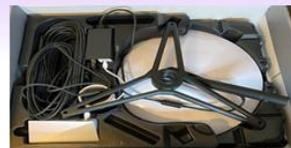
Starlink連網設備，如衛星天線、支撐架、Wi-Fi路由器、電源供應器
