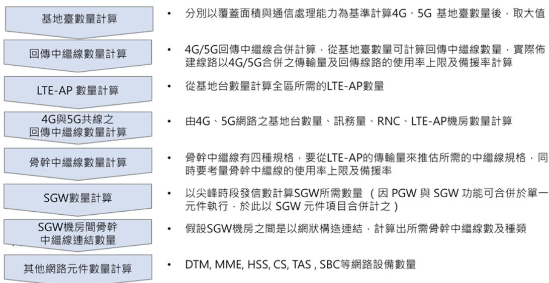
圖 3-7 模型網路元件計算步驟
