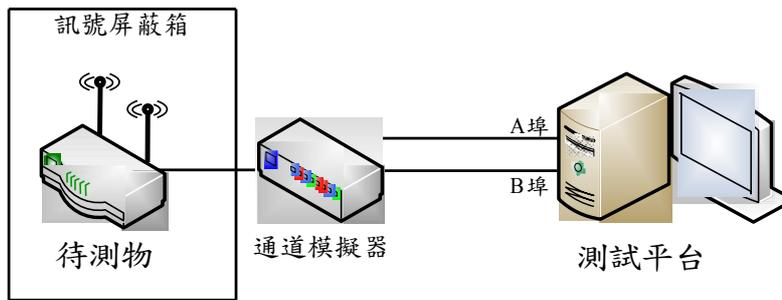
圖 5 吞吐量測試接續示意圖
