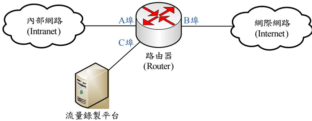
圖 7 流量錄製接續示意圖
