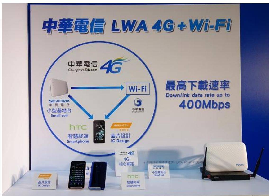
圖 11 我國小細胞基地臺及 WiFi 的 LTE-WLAN Aggregation
