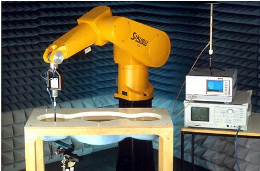
圖 4.2 已商業化的 SAR 量測系統（二）
