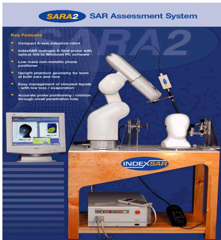
圖 4.1 已商業化的 SAR 量測系統（一）
