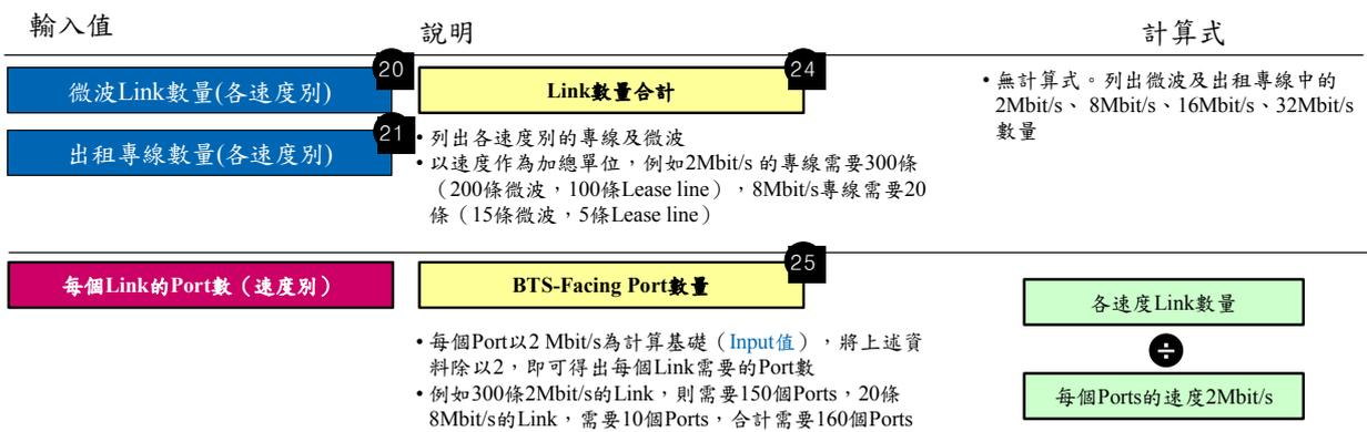
圖 7-58 BTS-Facing Ports 數量計算式
