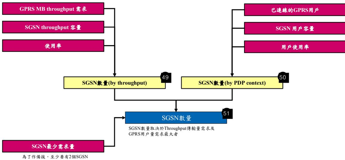
圖 7-80 SGSN 數量計算框架
