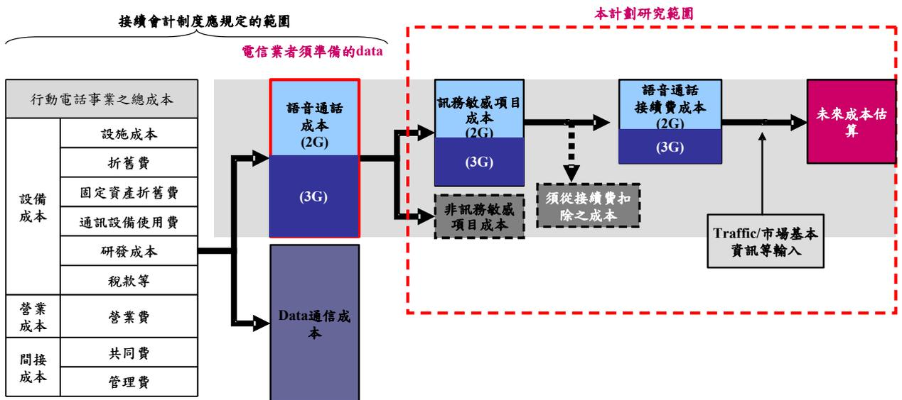
圖 2-8 行動網路接續費 Top Down 計算示意圖
