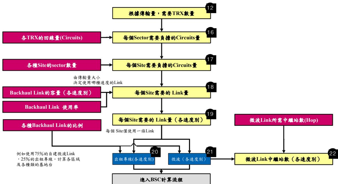
圖 7-53 Site-BSC Transmission 數量計算框架
