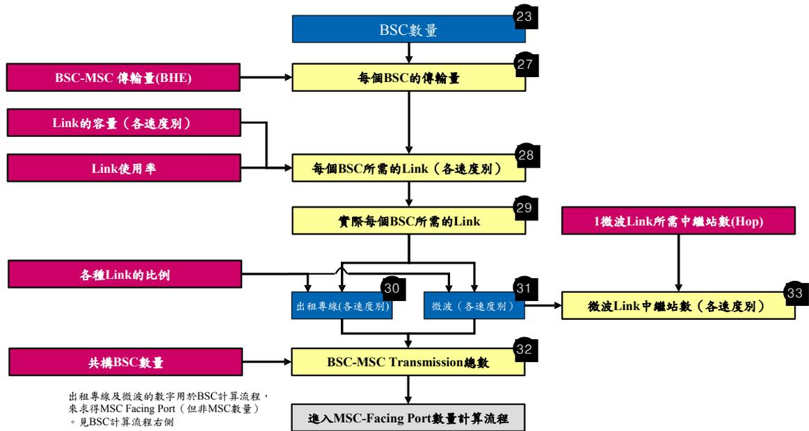
圖 7-60 BSC-MSC Transmission 計算框架
