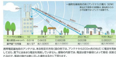
出典: 国土交通省「電波防護指針の適用範囲に関する調査報告書」(1997年7月) 電波法に基づき、E: 高さ40mのアンテナから200m離れた地点における電界の強さを算出した結果です。 (電磁界強度: 300kHz - 30MHz: 27.5 V/m, 30MHz - 300MHz: 2.75 V/m, 300MHz - 1.5GHz: 1.585 V/m)
