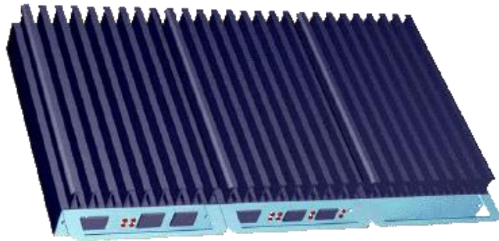
圖 3-10 PLC 頭端設備
