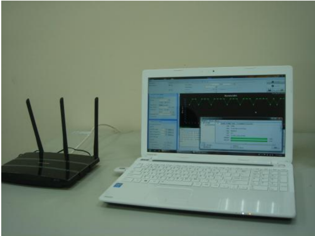
圖 4-5 測試接收網卡與無線路由器連線測試
