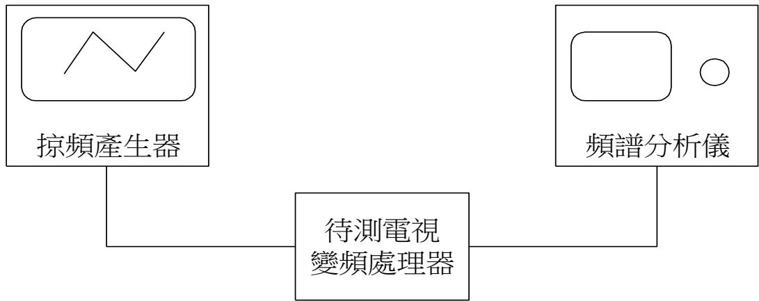
圖 6 頭端電視變頻處理器頻率響應測試裝置
