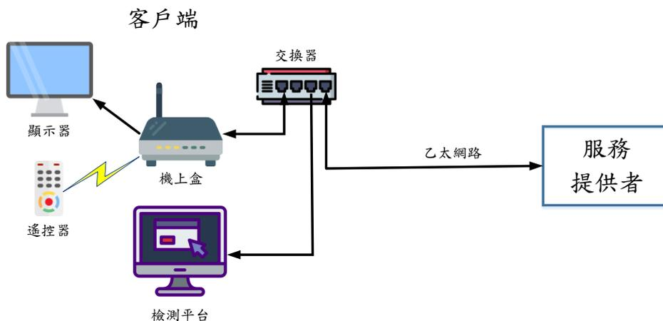
圖六、影音傳輸保護測試環境示意圖
