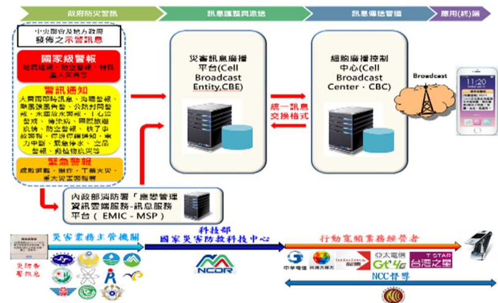
圖 3 災防告警系統架構圖
