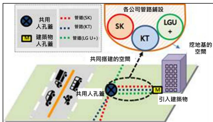
圖 2-28：韓國電信設備共同建置示意圖
