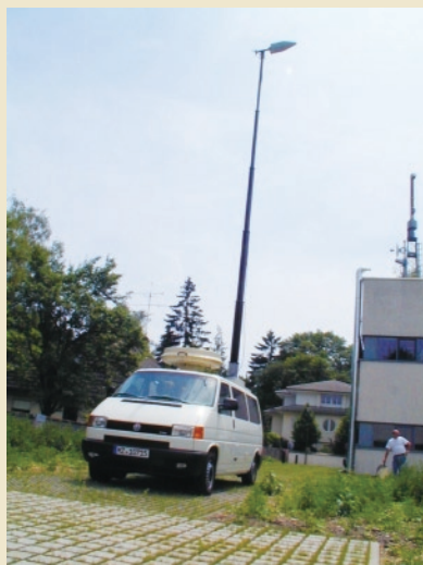
圖一、行動監測車 (頻段：20-30 MHz)
