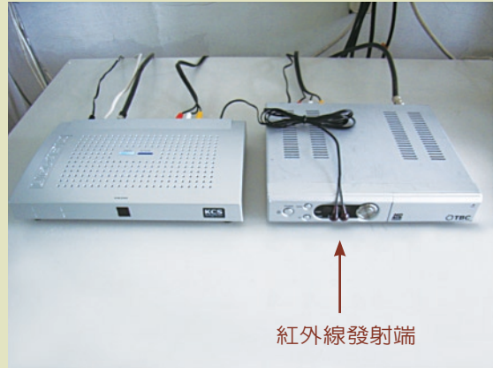
圖二、圖左方為網路電視盒，圖右方為數位機上盒由遠端利用紅外線發射端選臺
