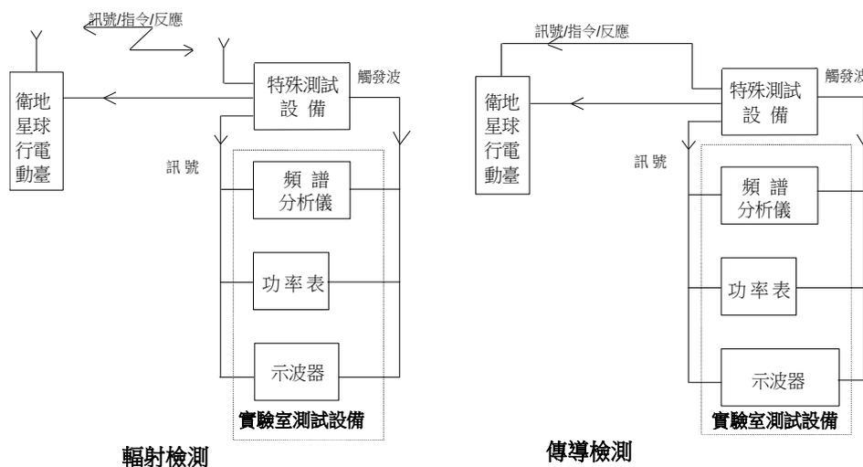
圖 H.1 監控功能檢測之測試安排
