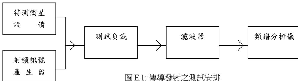
圖 E.1: 傳導發射之測試安排
