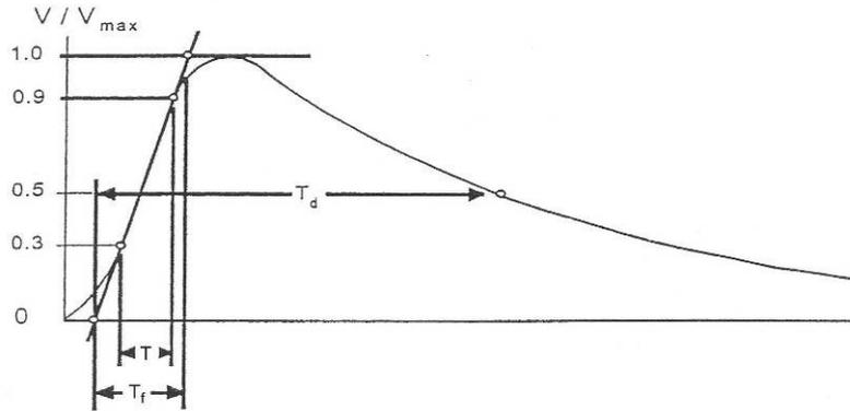
備註：短路雷擊電流波形如下圖所示
