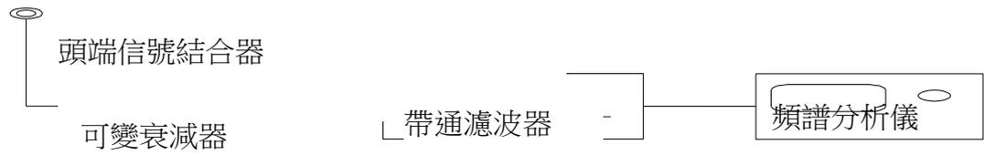
圖十七 上行控制信號頻帶測試裝置
