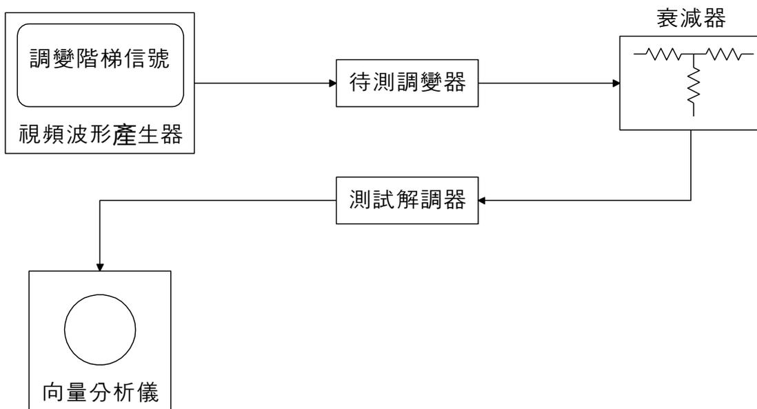
圖十六 頭端電視調變器差動相位測試裝置
