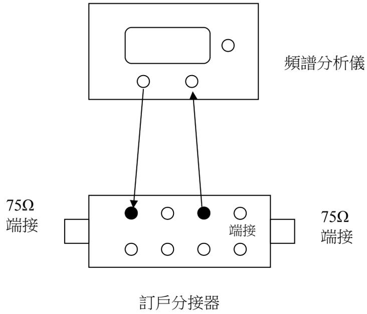
圖十 訂戶端終端隔離度測試裝置
