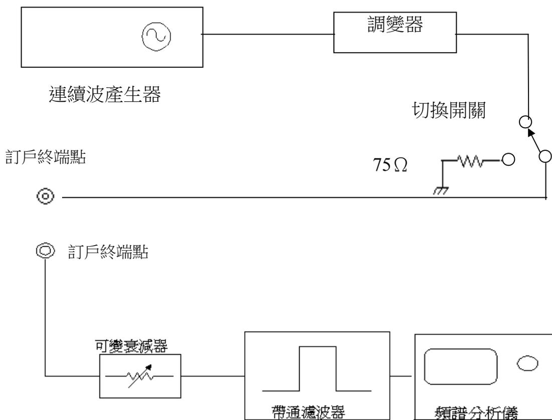
圖九 載波位準、載波雜訊比、載波合成拍差比、串調變比、載波交流聲調變比、禁用頻道及載波拍差比之測試裝置
