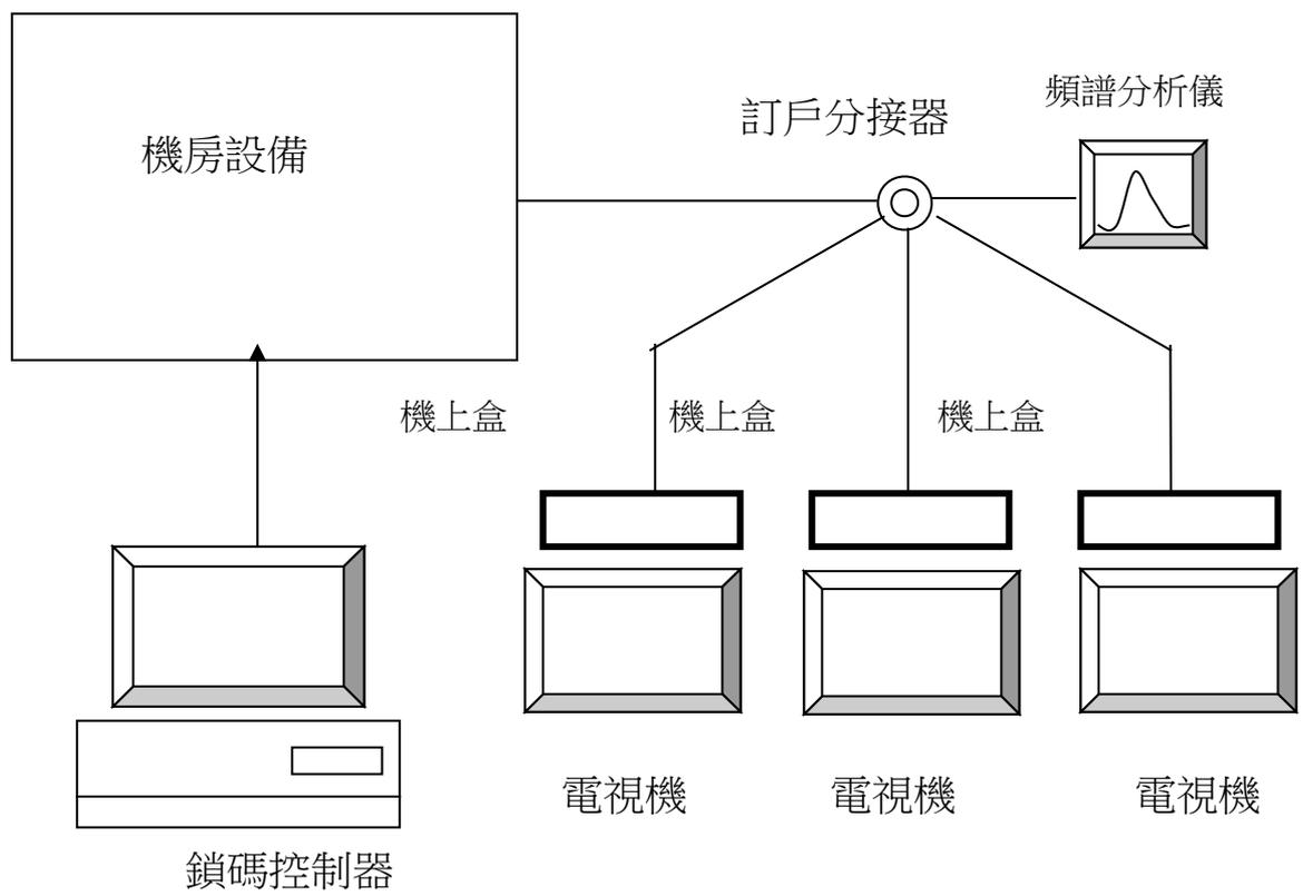
圖十八 定址鎖碼測試裝置
