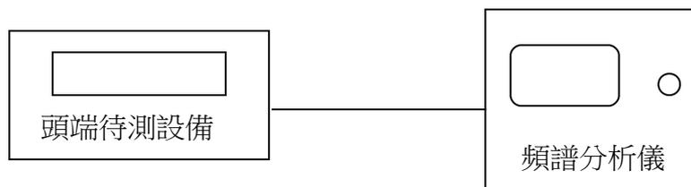
圖十二 頭端載波頻率測試裝置
