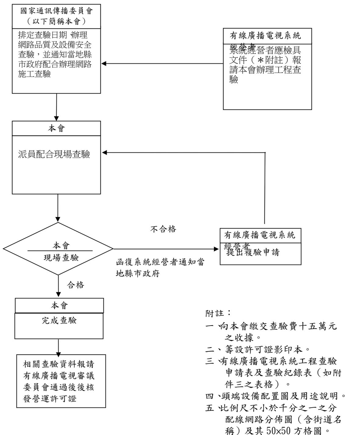
附圖一 新設系統工程查驗作業流程圖
