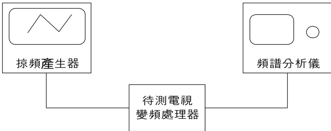
圖十三 頭端電視變頻處理器頻率響應測試裝置
