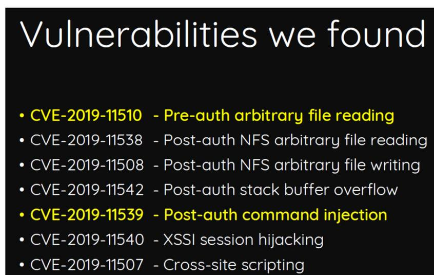
圖 10、臺灣 HITCON 找到的 SSL VPN 漏洞（來源：DEF CON 27 官網）
