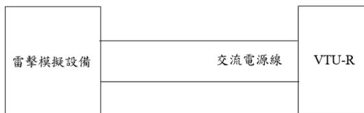
圖十七 交流電源線雷擊測試架構圖
