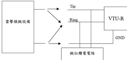
圖十六 U-R 介面雷擊試驗接線圖
