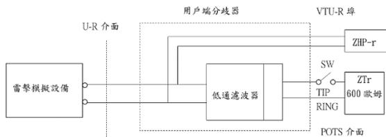
圖十一 雷擊試驗接線圖
