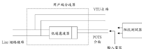
圖十 用戶迴路負載電容測試接線圖
