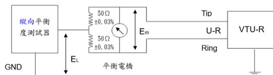
圖十四 縱向平衡度測試架構圖
