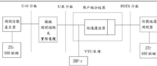
圖七 語音頻帶延遲失真測試接線圖
