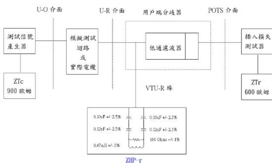
圖三 語音頻帶插入損失測試接線圖
