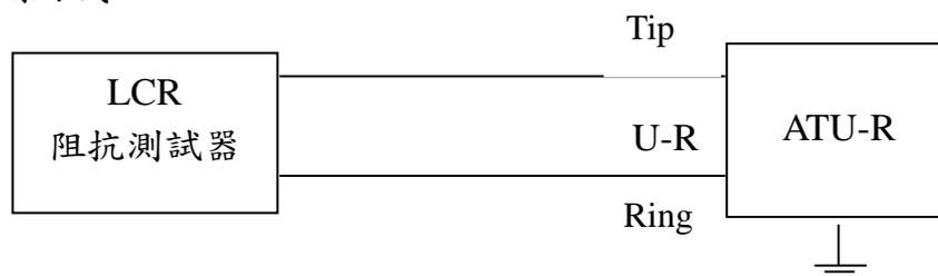
圖十五 ATU-R 輸入阻抗測試架構圖
