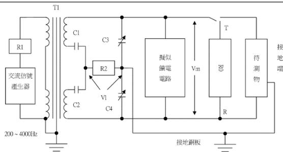
圖十二 橫軸平衡限制測試配置圖
