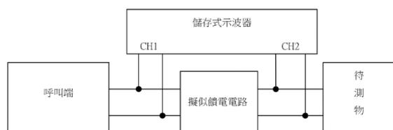
圖四十九 自動應答功能測試配置圖
