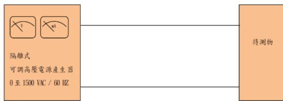
圖三 洩漏電流限制測試配置圖
