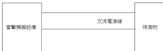
圖二 交流電源線雷擊測試配置圖
