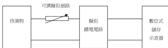
圖十八 信號時間測試配置圖
