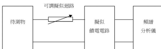
圖十六 頻率組合測試配置圖
