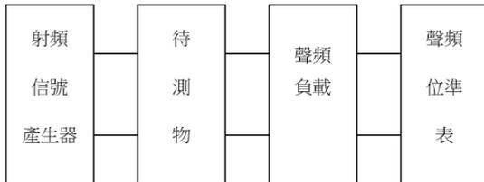
圖三十五 信號與雜訊比測試配置圖
