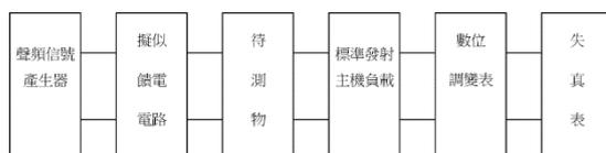
圖三十一 音頻失真測試配置圖
