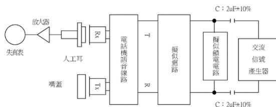
圖二十七 受話失真度測試配置圖
