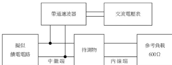
圖四十 靜態雜音測試配置圖
