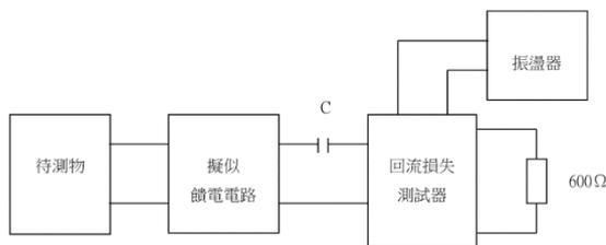
圖十四 回流損失測試配置圖
