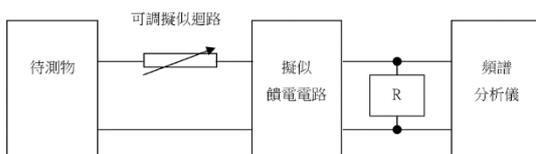
圖十七 信號位準測試配置圖
