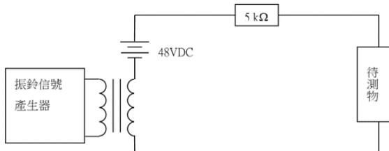
圖五 振鈴響應測試配置圖
