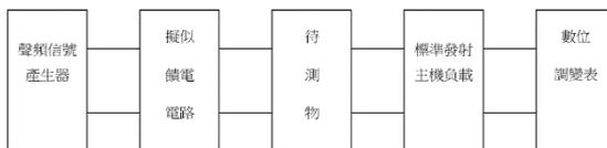
圖三十 調變靈敏度測試配置圖
