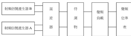
圖三十七 混附響應拒斥測試配置圖
