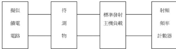
圖二十九 載波頻率測試配置圖
