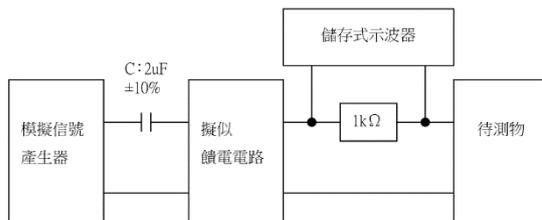
圖四十三 直流界限測試配置圖
