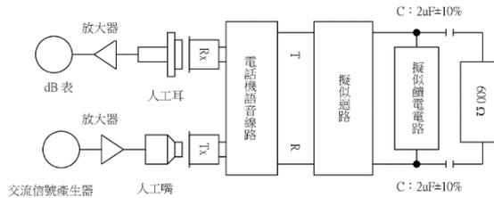
圖二十五 側音當量測試配置圖
