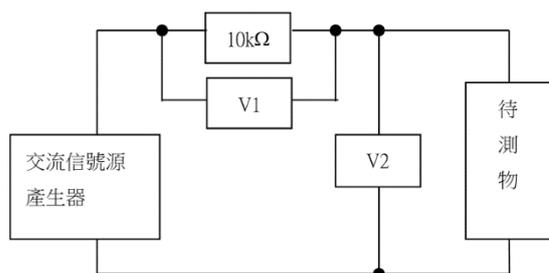
圖八 開路時交流阻抗測試配置圖
