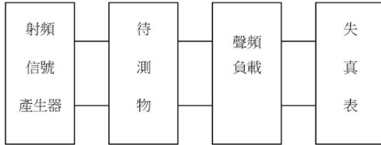
圖三十四 音頻失真測試配置圖
