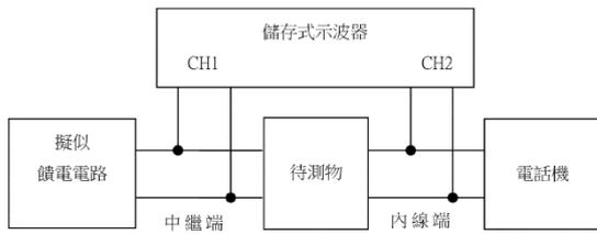
圖三十九 切斷中繼線測試配置圖
