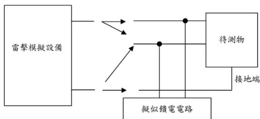
圖一 雷擊測試配置圖
