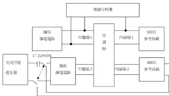
圖四十二 串音損失測試配置圖
