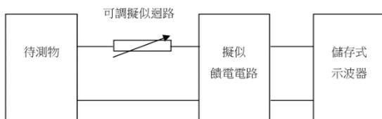
圖十五 脈衝撥號測試配置圖
