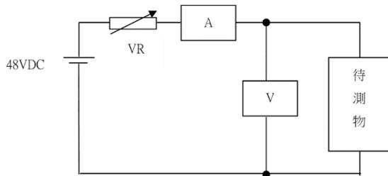
圖十 閉路時直流電阻測試配置圖
