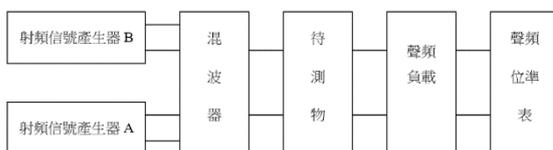
圖三十六 鄰波道拒斥測試配置圖
