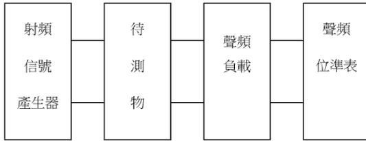
圖三十二 可用靈敏度測試配置圖
