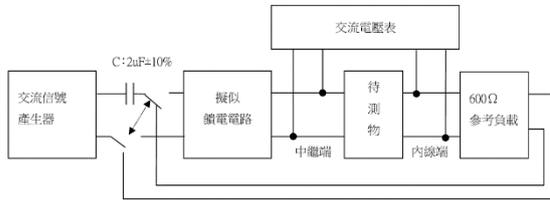
圖四十一 傳輸損失測試配置圖
